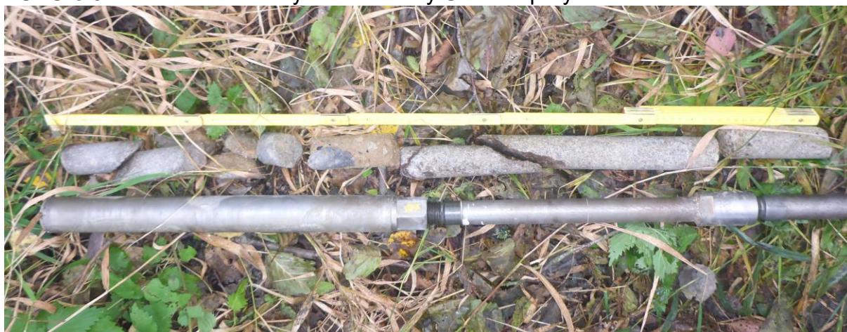
FOTO č.3.2: Dokumentace vývrtu ze sondy SK1 do opěry 1
