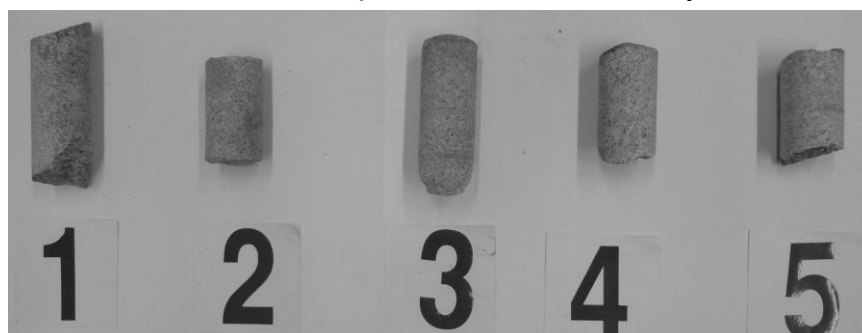
FOTO č.3.3: Dokumentace vzorků pro destruktivní zkoušky kamene
