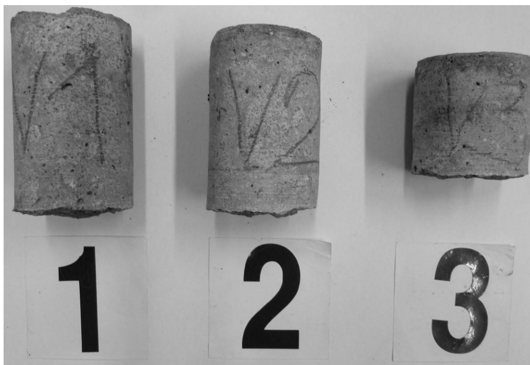
Foto č.3.1: Dokumentace vývrtů pro destruktivní zkoušky pevnosti v tlaku betonu NK
